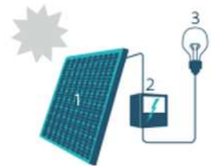
1. Zonnepaneel | 2. Omvormer | 3. Elektrische toestellen
